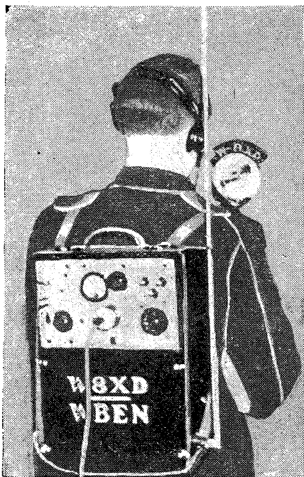
Рис. 2. Портативный УКВ-передатчик, работающий на 37 600 кс, применяемый для радиорепортажа
